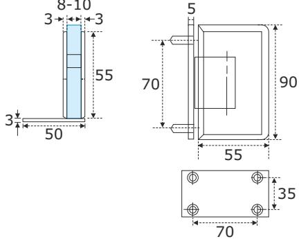
Μεντεσές οροφής - δαπέδου ρυθμιζόμενος περιστροφής (τοίχο - γυαλί)
