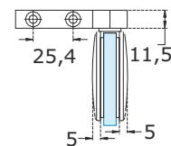
Μεντεσές οροφής ρυθμιζόμενος περιστροφής (δεξιός) (τοίχο - γυαλί)
