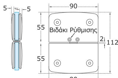
Μεντεσές οροφής ρυθμιζόμενος περιστροφής (αριστερός) (τοίχο - γυαλί)
