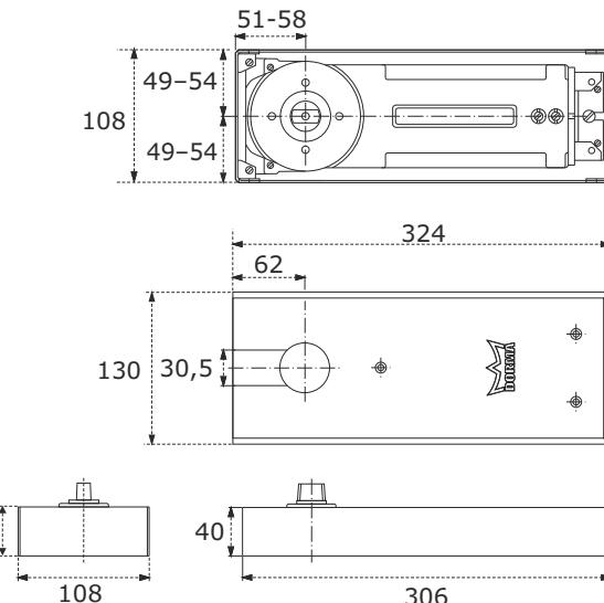
Μηχανισμός δαπέδου DORMA (BTS80) για πόρτες ιδιαίτερου ύψους & βάρους. Βαρέως τύπου.
